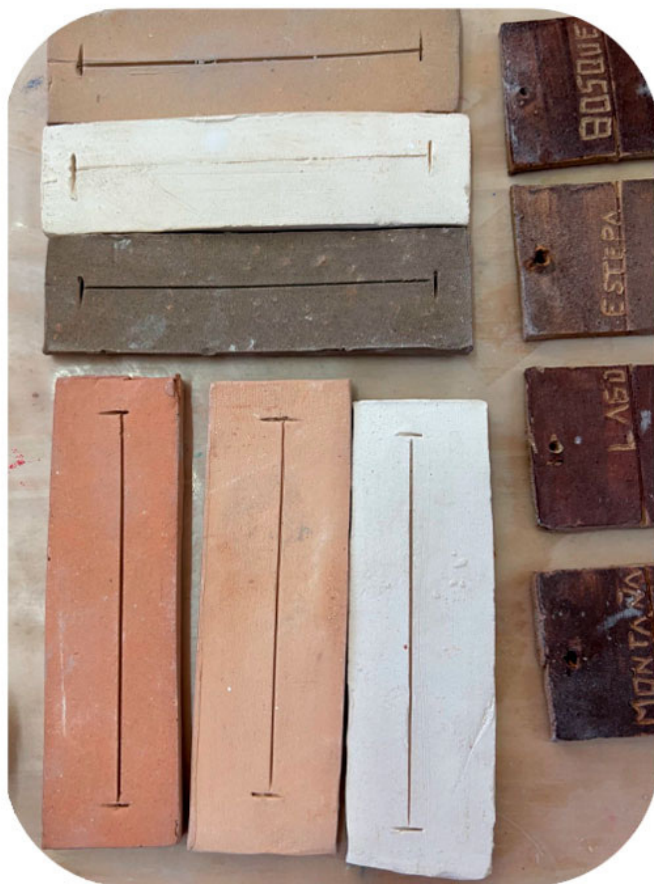
Passo 7: Barras de testes - servem para avaliar o grau de retração do material e seu comportamento durante a queima.
